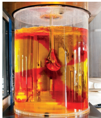
Les têtes de mélange à jets rotatifs Iso-Mix injectent les fluides, gaz ou poudres par des buses à jets rotatifs sans provoquer de rotation du liquide.
